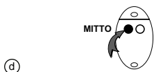
Die erste Sendetaste des Handsenders drücken - die LED DL1 am Empfänger blinkt wieder
